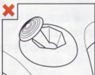
この時に、3Dスティックが傾いている場合（左上の図）、傾いた状態が「ニュートラルポジション」と設定されます。このようにニュートラルポジションの位置がズレた状態では、3Dスティックが正常に操作できなくなります。
